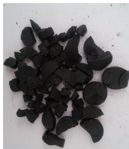
Клинкер №16, обожженный при 1340 °С
