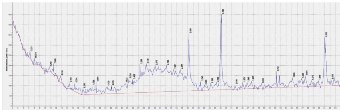
Рисунок 7 – Рентгенограмма тефритобазальта Даубабинского месторождения
