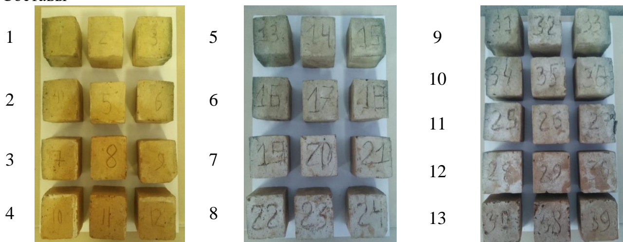
Рисунок 41 - Фотографии образцов 5x5x5 см (1-13 состав)
